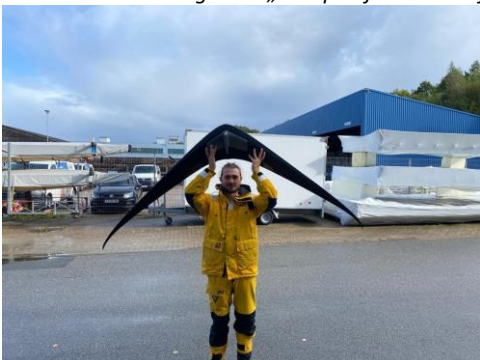
Abbildung 2: Das Heck-Foil des V_REX nach den biometrischen Design des „Indopazifischen Sailfishs“
